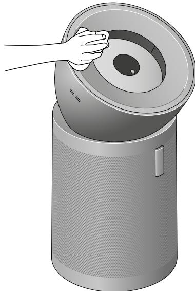
Proverite da li na ulaznim senzorima, na levoj strani konusnog pojačavača, ima prašine i ostataka.
